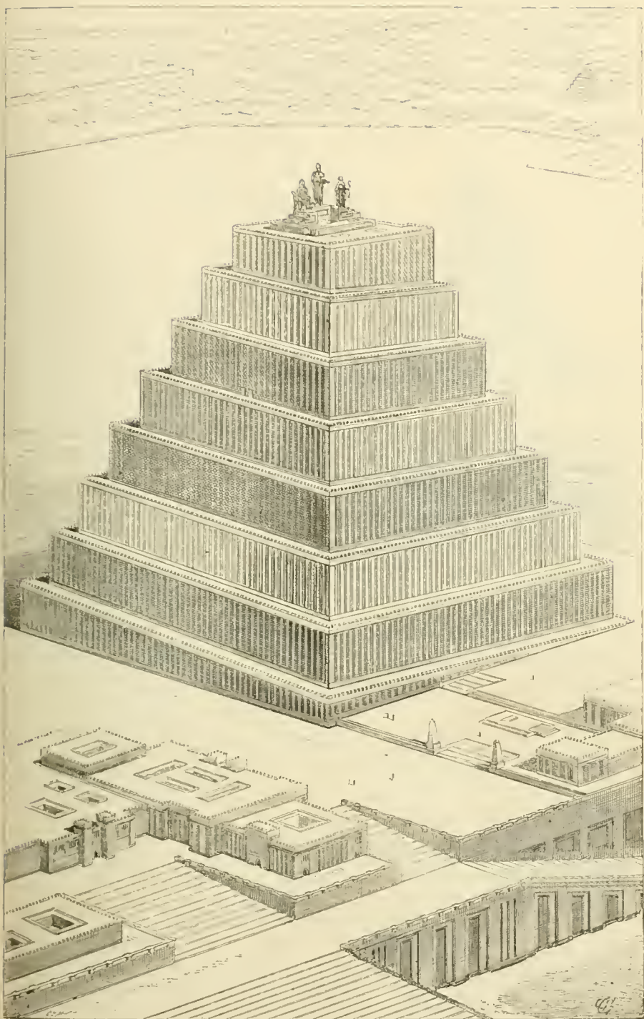
173. — Temple chaldéen à rampe unique et sur plan carré. Restitution par Ch. Chipiez.
